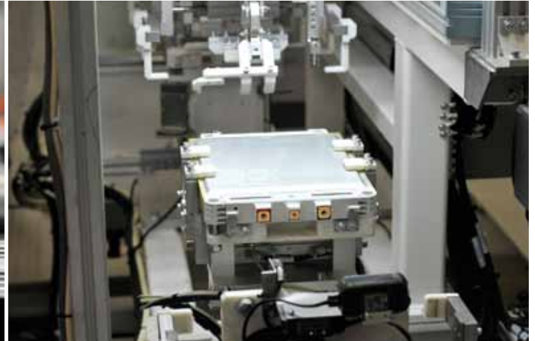
MONTERING. Fyra celler staplas och bildar en modul. Varje modul placeras i ett metallfodral för att skyddas. Modulerna skickas sedan vidare till montering av batteriet som innanför skalet har 48 moduler och viss elektronik.
