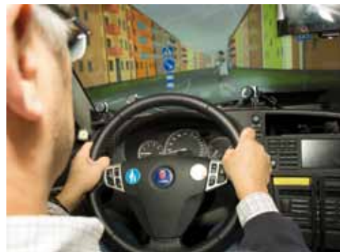
KÖRSIMULATOR. I Linköping planerar VTI ett försök där man med hjälp av en körsimulator ska försöka ta reda på om förare med synbortfall kan kompensera detta med en mer aktiv avsökning av körbanan.
