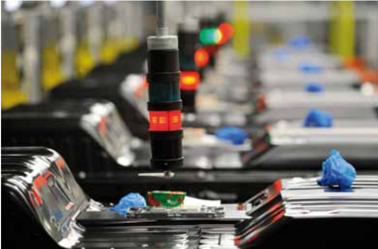
LADDNING. Efter lamineringen fylls elektrolyten på, vätskan som tillåter jonerna att vandra till/från de positiva till de negativa lagren i cellen. Därefter åldras cellerna innan de kontrolleras och laddas.
