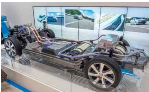
Lyfter man karossen från Toyotas chassi hittar man tekniken för gas-tankning, lokal elproduktion i bilen med hjälp av en bränslecell och den elektriska drivlinan.
