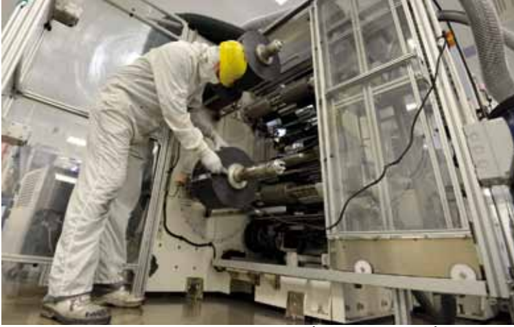
KÄRNAN. Elektrodrarna, anoder eller katoder beroende på polaritet, kommer på stora rullar som delas, torkas och skärs till ark. Elektrodarken är en del av kärnan i en battericell.
