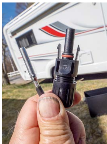
4 Vattentäta snabbkopplingar mellan solpanelen och kontrollenheten gör att panelen kan monteras utanpå husbilen medan resten monteras inne i husbilen. Allt kan enkelt flyttas.
