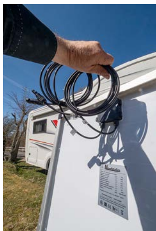
5 Bak på panelen finns lite tekniska data och två kablar med snabbkoppling. Panelen väger bara några kilo.
