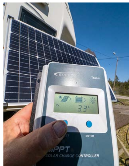
11 När systemet var igång gav det mellan 3 och 5 amperes laddström under en solig aprildag.
