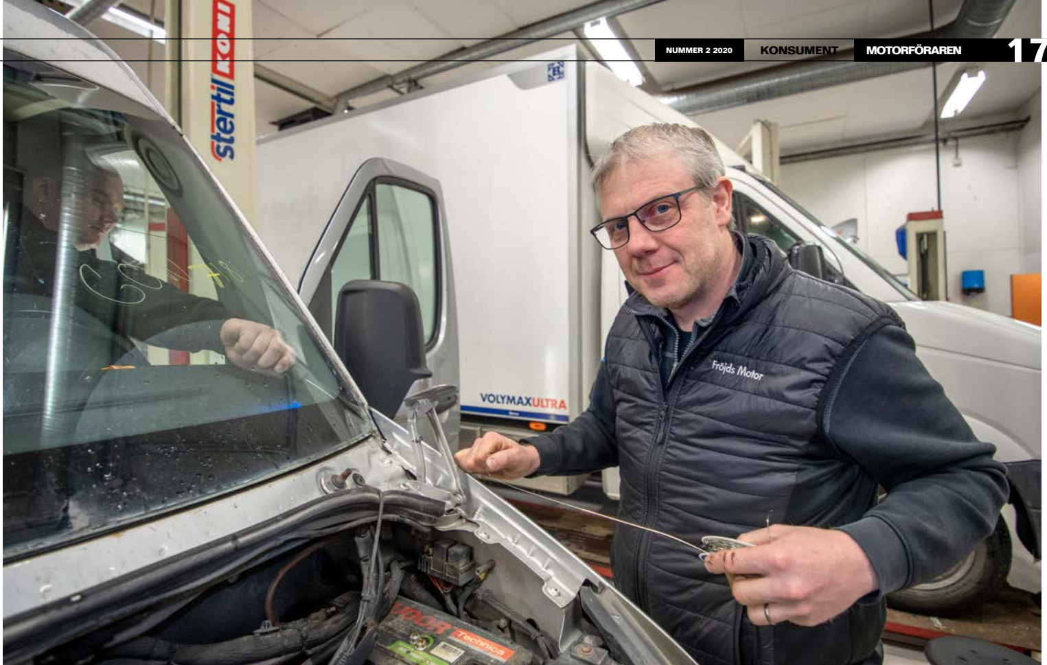
1. När den gamla rutan ska lossas använder man en ståltråd som träs igenom den gamla limningen.
