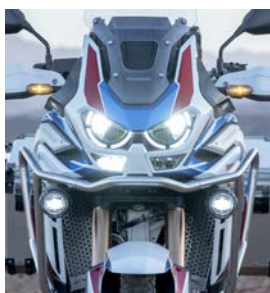
LED-belysningen med DRL är numera standard. De båda "kurvljus" tänds vid nerlägg. Extraljuset är tillval.
