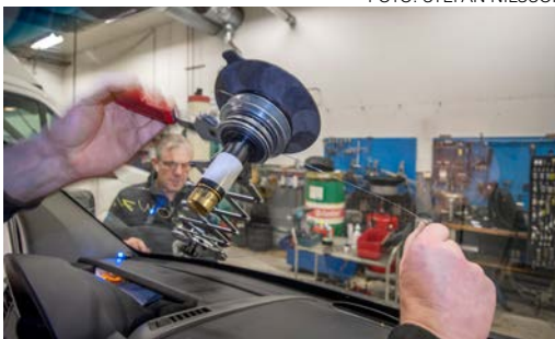
3. När ståltråden lagts runt hela rutan spänns den med ett speciellt verktyg som åter sig igenom den gamla limfog.
