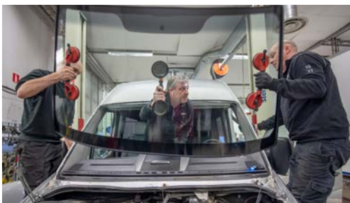
9. När det är dags att montera den tunga rutan är det bra att vara flera. Särskilt på en hög bil. Rutan måste komma rätt med en gång. Det går inte att skjuta runt den. Mattis får hjälp av Magnus Fransson (t.v.) och Mathias Lagercrantz.
