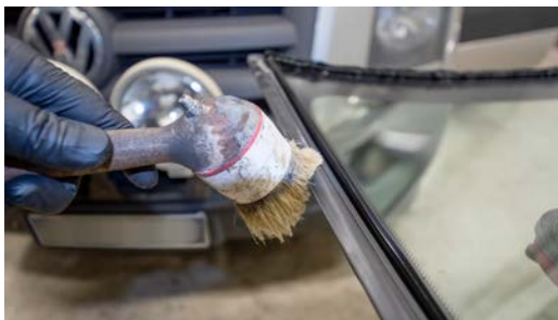
8. Gummilisten runt rutan får en lätt strykning med smörjmedel för att den lätt ska komma på plats mot plåtkanten.
