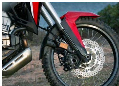
Bromsarna känner vi igen från den tidigare AT:n. Dubbla 310 mm skivor med fyrkolvssok från Nissin ger bra känsla och är fullt tillräckliga. Avstängbar ABS.
