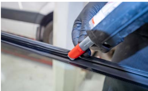
7. Det krävs lite erfarenhet och en van hand för att lägga en lagom tjock limfog enligt tillverkarens instruktioner.
