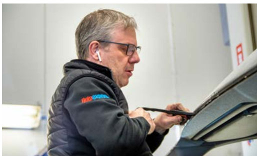
6. Alla gamla limrester måste skrapas bort innan primern läggs på och rutan med limmet lyfts på plats.
