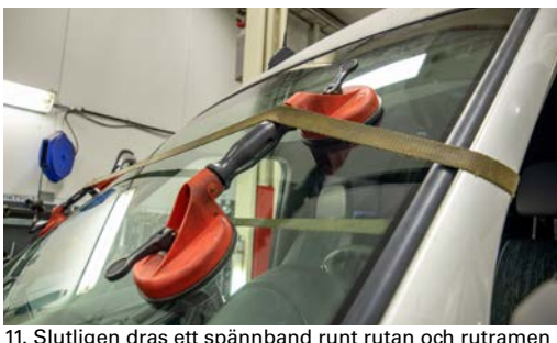
11. Slutligen dras ett spännband runt rutan och rutramen för att limmet ska ligga under press medan det härdras i värmen inomhus under natten.
