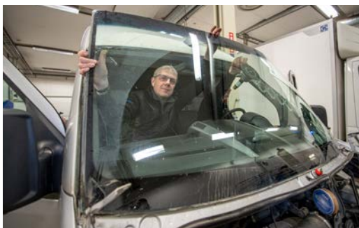
4. Rutan är lossad och Mattis får hjälp av Mathias Lagercrantz att lyfta ut den.
