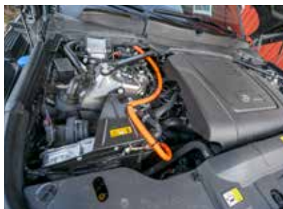
MOTORTROLLERI. Under huven har den klassiska V8:an fått ge sig för en rak fyra och laddhybridteknik som ger motsvarande prestanda men lägre förbrukning.
