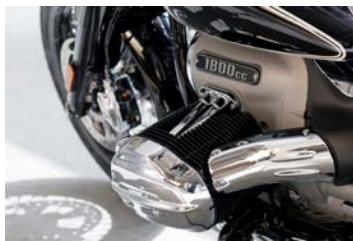
VRIDSTARK. Den 1 802 kubik stora boxermotorn är hojens centralpunkt. Största delen av maskinens vridmoment återfinns mellan 2 000 – 4 000 varv.
