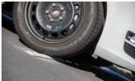
Rullkomforten bedöms över olika typer av gupp och vägskarvar.
