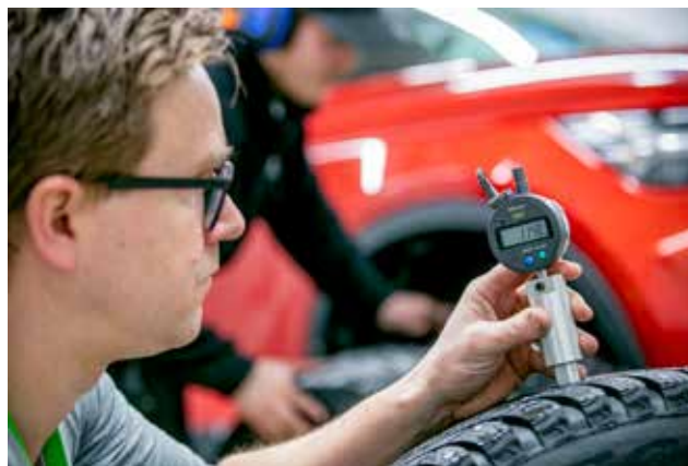
Vi kontrollerar dubbutsticket när däcken är nya och under testets gång.
