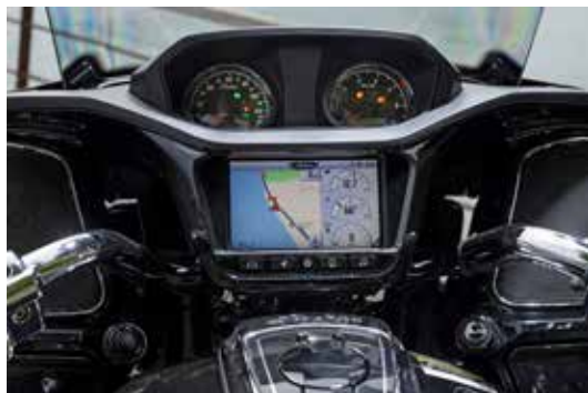
Analoga mätare ihop med en sju tum stor TFT-display är en lyckad kombination. Apple Carplay är standard.
