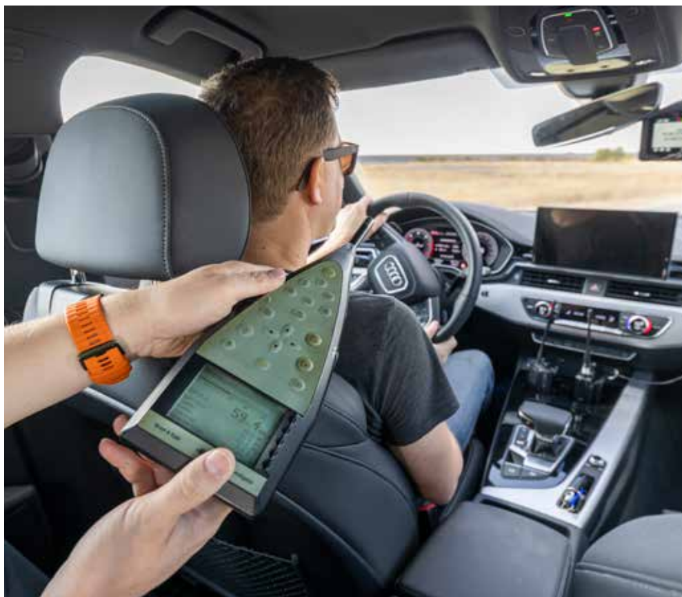
BULLERMÄTNING. Vi mäter buller på slät och grov asfalt. Ljudet spelas in under tio sekunder. Sedan gör vi om samma sak och lyssnar om däckerna ger vassa eller behagliga frekvenser för trumhinnan.
