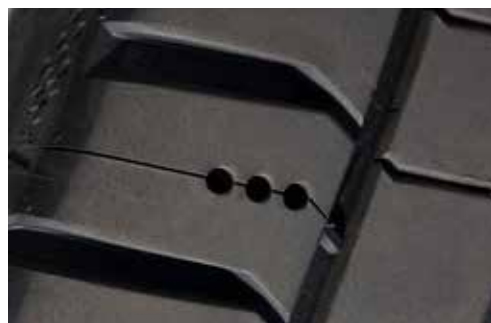
FIGG DETALJ. Markeringar på slitbanans yttersida på Hankook och Michelin varnar för snedslitage.
