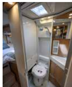
VRIDBAR TOALETSTOL. En smart lösning med en toalettstol som kan vridas in under den ena sängen och ge mer utrymme i duschen.
