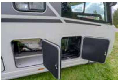
Högersidans lastutrymme och skåpet för två gasflaskor.
