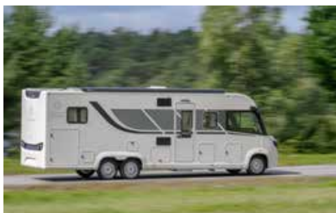
STOR OCH STADIG. Le Voyageur LVX 8,7 är en stor husbil som går stadigt och komfortabelt tack vare luftfjädring och boggi.
